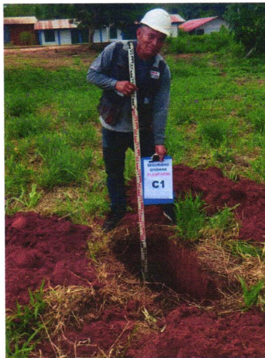
REGISTRÓ ALTIMETRICO DE EXCAVACIONES CALICATA C-1
