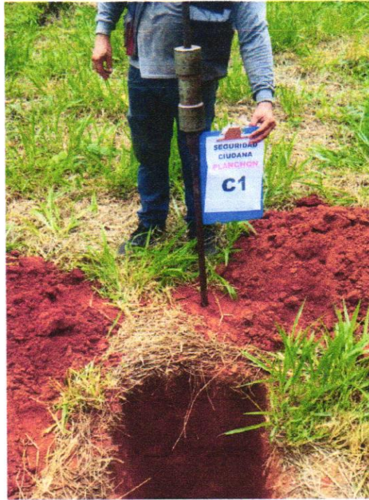
ENSAYO INSITU CON DPL (NTP -339.159 DIN 4094) CALICATA C-1
